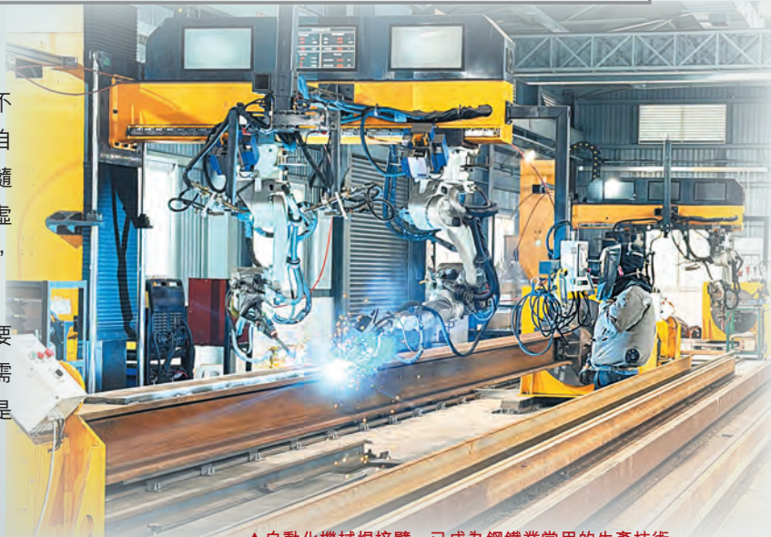
▲自動化機械焊接臂，已成為鋼鐵業常用的生產技術。
